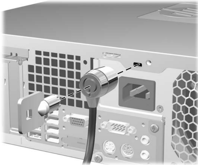
Figura C-1 Instalación de un bloqueo de cable
